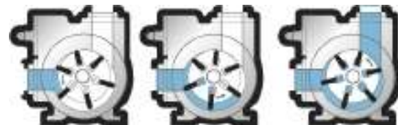
Как центробежный лопастной насос работает
